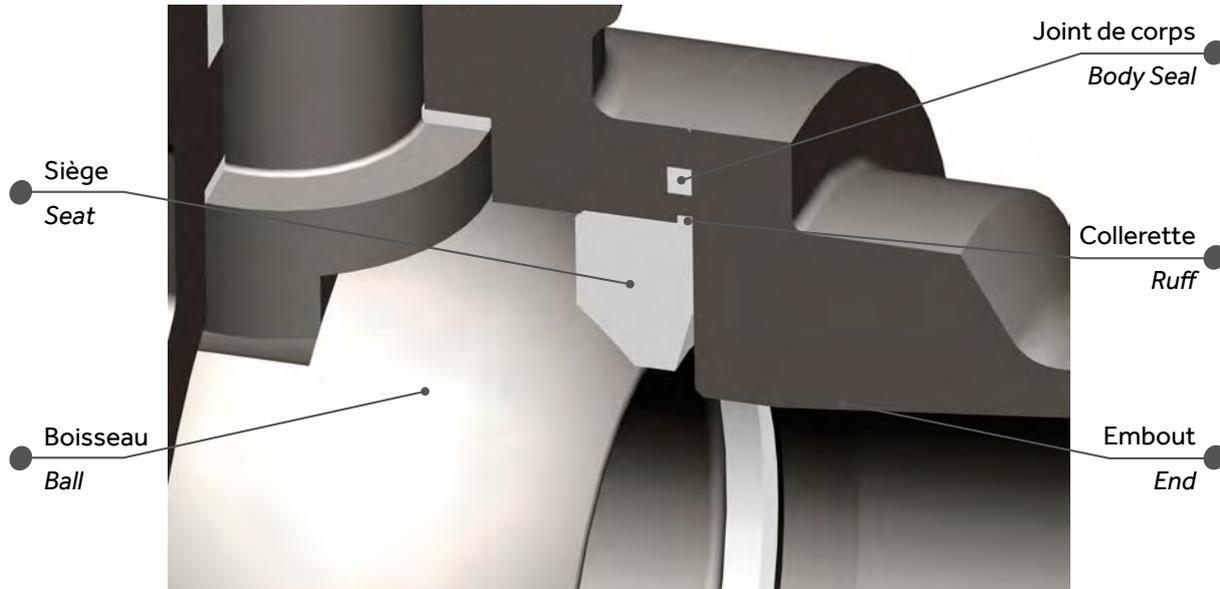
Joint de corps encastrés qui garantissent l'étanchéité intérieur / extérieur.
